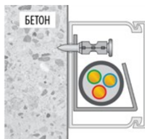
Рисунок 19 - Монтаж ОКЛ в кабельном канале при помощи дюбель-гвоздя для газового монтажного пистолета к поверхности из кирпича/бетона
